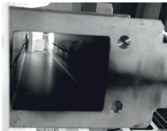
Рис. 3. Внутреннее пространство магнитного канала МС2 со следами пучка
