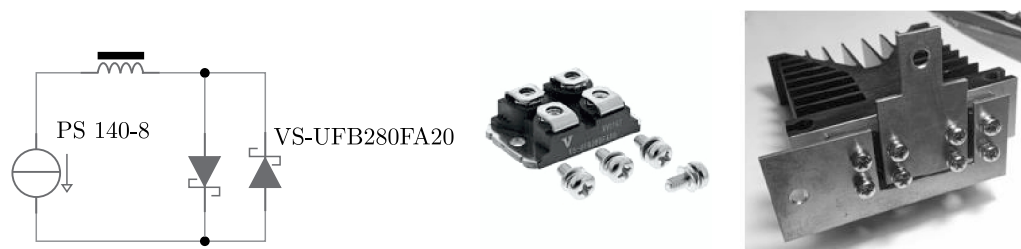
Рис. 1. Электронное устройство подавления пульсаций для EVPU PS 140-8
