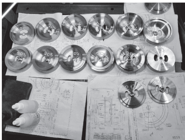
Рис. 6. Комплект ускоряющих ячеек на этапе проведения измерений и доработки
