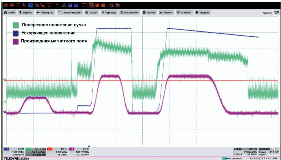
Рис. 2. Сигналы электроники ДПП ВЧ-станций. Цена деления по оси времени — 200 мс, по вертикали — 1 В
