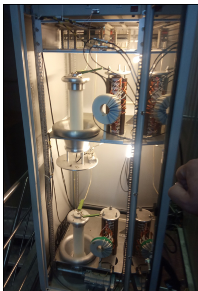
Рис. 8. Опытный образец генератора с тиристорными коммутаторами на испытаниях
