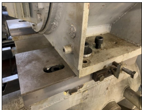
Рис. 1. Переходная пластина гелиевого винтового компрессорного агрегата «Каскад-80/25» № 1
