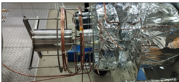
Рис. 3. Сборка гелиевого рефрижератора
