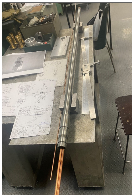
Рис. 6. Сборка узла источника протонов
