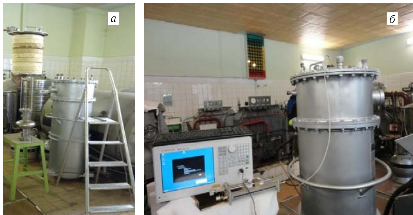
Рис. 17. Отдел криогенных исследований НПЦ по материаловедению НАН Белоруссии: подготовка резонатора к погружению в криостат (а); стенд для криогенных испытаний резонаторов (б)
