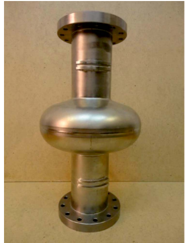
Рис. 2. Корпус резонатора, полученный из FNAL
