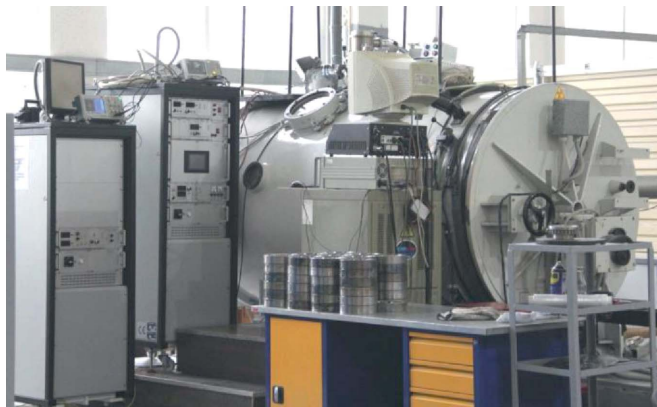
Рис. 11. Участок электронно-лучевой сварки в ФТИ НАН Белоруссии: установка для ЭЛС
